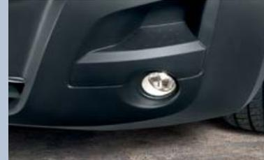
**Front-Nebelscheinwerfer.** Versenkt platziert und somit geschützt bei leichten Kollisionen.
