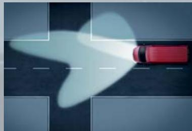
**ESP®.** Das Elektronische Stabilitätsprogramm mit Berg-Anfahr-Assistent, Anhänger-Stabilisierungsprogramm und optimierter Traktionskontrolle hält den Opel Movano in kritischen Fahrsituationen auf Kurs. Das Ansprechverhalten wird adaptiv dem Beladungszustand angepasst.
