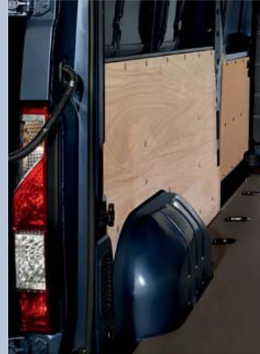
**Laderaumschutz.** Maßgeschneiderte halb- oder vollflächige Seitenpaneele aus Holz sowie ein harzbeschichteter Holzboden schützen den Laderaum vor Beschädigung.
