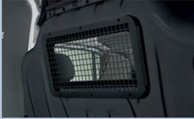
**Schutzgitter für verglaste Trennwand.**
