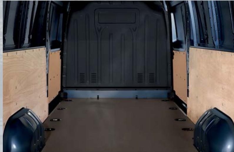
**Laderaumschutz.** Maßgeschneiderte halb- oder vollflächige Seitenpaneele aus Kunststoff sowie ein harzbeschichteter Holzboden schützen den Laderaum des Opel Movano vor Beschädigung.
