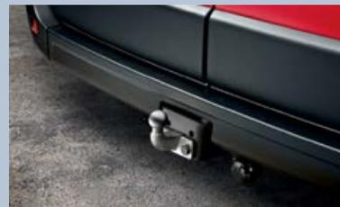
**Anhängerzugvorrichtung.** Bietet erweiterte Transportmöglichkeiten mit bis zu 3 t Anhängelast. Der Kugelkopf ist abnehmbar.
