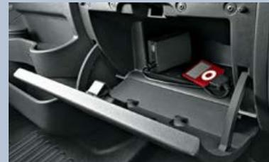
**Multimedia-Verbindung.** Mit dem Aux-In- und dem USB-Anschluss im Handschuhfach können mobile Digitalgeräte mit den Lautsprechern im Auto verbunden und per Fernbedienung gesteuert werden.
