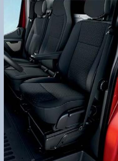
**Komfortsitz.** Höhenverstellbarer, tief konturierter Sitz mit einstellbarer Lordosenstütze und Armlehne. Optional erhältlich für Fahrer und Beifahrer.
