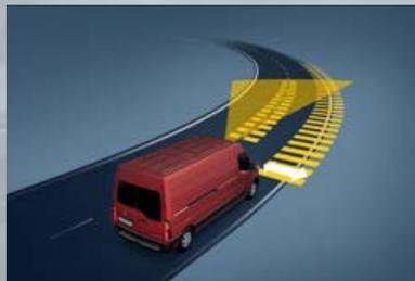
**Statisches Abbiegelicht.** Beim Setzen des Blinkers vor dem Abbiegen leuchten die Scheinwerfer den Weg perfekt aus.
