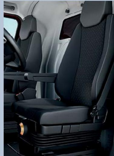
**Schwingsitz Fahrerseite.** 4-Wege-einstellbarer Fahrersitz mit regulierbarer Luftfederung und Armlehne für optimalen Sitzkomfort auf langen Strecken.
