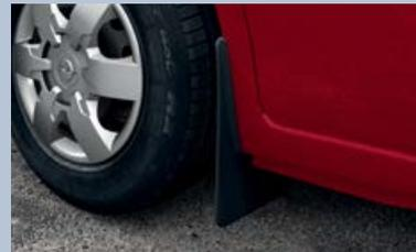
**Schmutzfänger.** Im Nutzfahrzeug-Alltag wird schnell eine Menge Staub aufgewirbelt: Diese Schmutzfänger verhindern Lackschäden durch Steine und überflüssige Verschmutzung der straßen nahen Bereiche.
