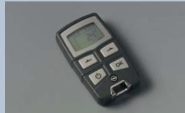
**Standheizung mit Fernbedienung.** Alle relevanten Einstellungen können dank des Displays außerhalb des Fahrzeugs vorgenommen werden.
