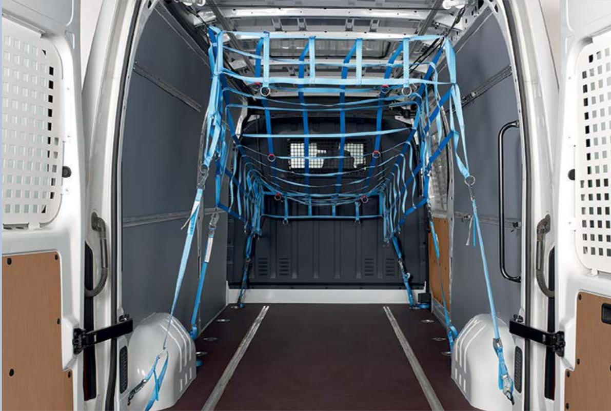
**Verschiebbares Trenn-Netz.** Wird an Dach und Boden befestigt und sichert leichte Ladungen. Lässt sich zur Begehung öffnen.
