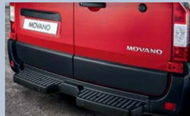
**Trittstufe.** Die rutschfeste Stufe erleichtert den Einstieg in den Laderaum. Optional mit Vorderradantrieb, serienmäßig mit Hinterradantrieb.
