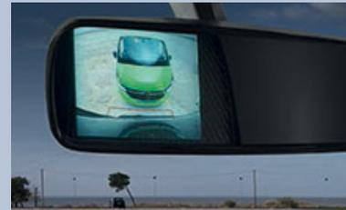
**Rückfahrkamera.** Der 3,5" große LCD-Bildschirm der Rückfahrkamera, untergebracht in der Sonnenblende des Fahrers, wird automatisch beim Einlegen des Rückwärtsgangs aktiviert.
