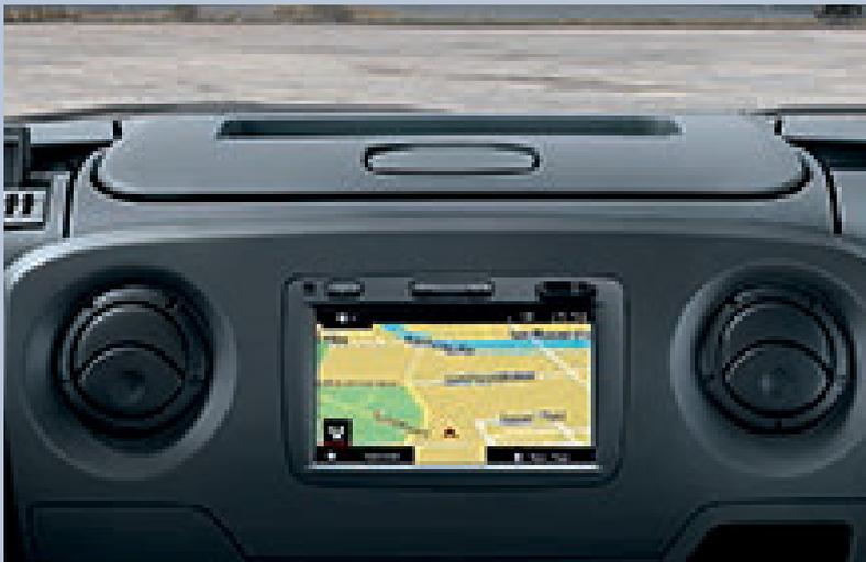
**Navi 50 IntelliLink.** Dieses Navigationssystem bietet hervorragende Leistung zum günstigen Preis. Der 7"-Farb-Touchscreen ist im perfekten Blickwinkel in der Mitte des Armaturenbretts integriert. Die dynamische Anzeige in 2-D- oder 3-D-Vogelperspektive beinhaltet auch aktuelle TMC-Verkehrsmeldungen. Die Aktualisierung des Kartenmaterials erfolgt über USB.
