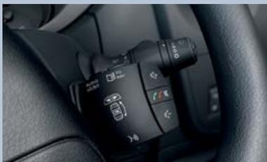
**Radiofernbedienung an der Lenksäule.** Zur sicheren und einfachen Bedienung der Infotainment-Systeme.
